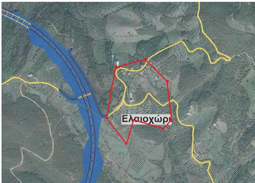
Χάρτης 18: Διέλευση Ιόνιας Οδού από περιοχή οικισμού Ελαιοχωρίου (με μπλε χρώμα απεικονίζονται τα ορύγματα εκατέρωθεν του άξονα της οδού)
