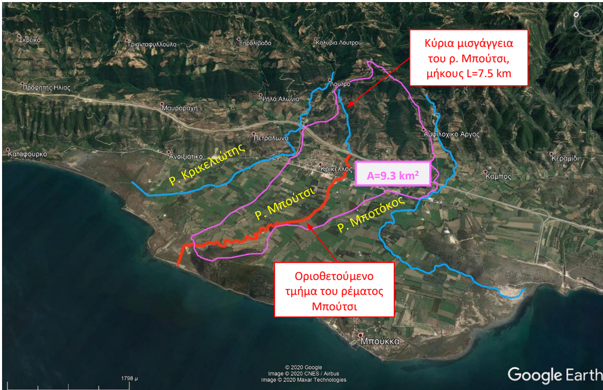
Εικόνα 1.3-4: Απόσπασμα δορυφορικού χάρτη της περιοχής μελέτης όπου απεικονίζονται τα όρια της λεκάνης απορροής του ρέματος Μπούτσι, έκτασης 9.3 km 2 (μωβ γραμμή), η κύρια μισγάγγεια (μπλε γραμμή) μήκους 7.5 km και το εξεταζόμενο τμήμα (κόκκινη γραμμή) μήκους 4885 m. (Πηγή: Google Earth)
